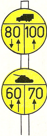
Fig. 8. Tweerichtingsverkeer wielvoertuigen klasse 80 rupsvoertuigen klasse 60. Eénrichtingsverkeer wielvoertuigen klasse 100 rupsvoertuigen klasse 70.
