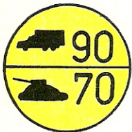
Fig. 6. Brug of vlot voor éénrichtingsverkeer: wielvoertuigen klasse 90 rupsvoertuigen klasse 70.
